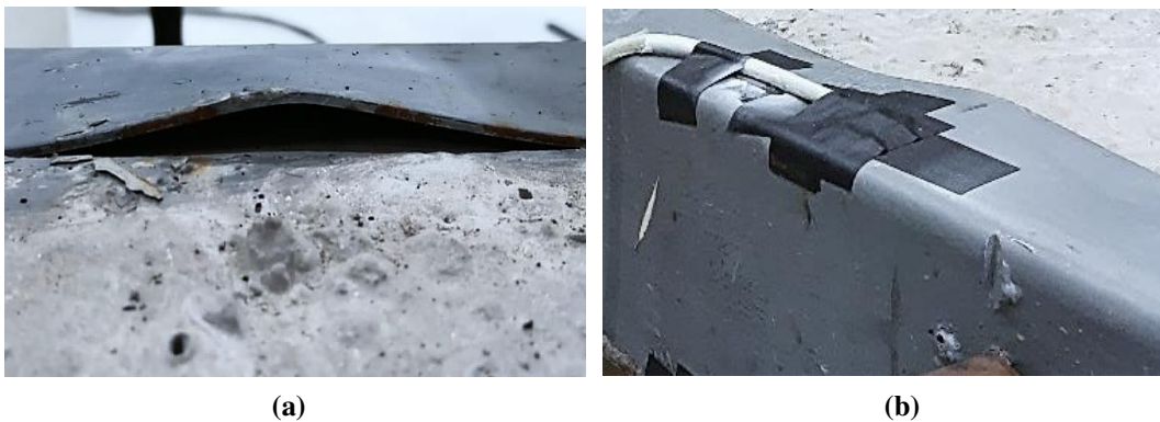
Figura 3.8 – Instabilidade da mesa de aço comprimida. (a) Modelo L_2 ; (b) Modelo L_3 .
