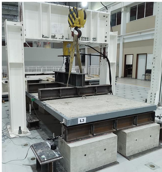
Figura 3.4 – Ensaio experimental das lajes de concreto pré-moldado envelopadas (LBE/UFV).
