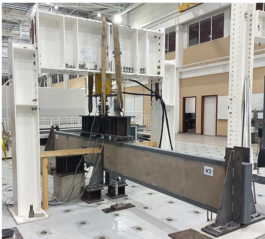
Figura 2.5 – Ensaio experimental das vigas de concreto pré-moldado envelopadas (LBE/UFV).
