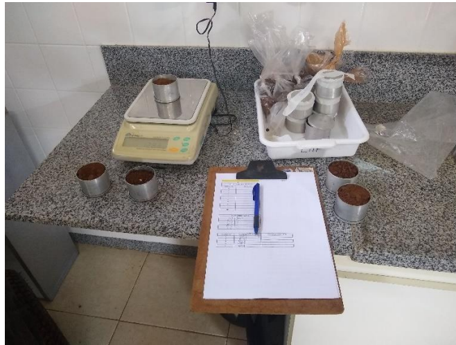
Figura 13 - Balança (modelo BK8000 da Gehaka) para pesagem de amostras para a determinação de umidade do solo, Laboratório de Hidrologia Florestal - LHF/UFV.
