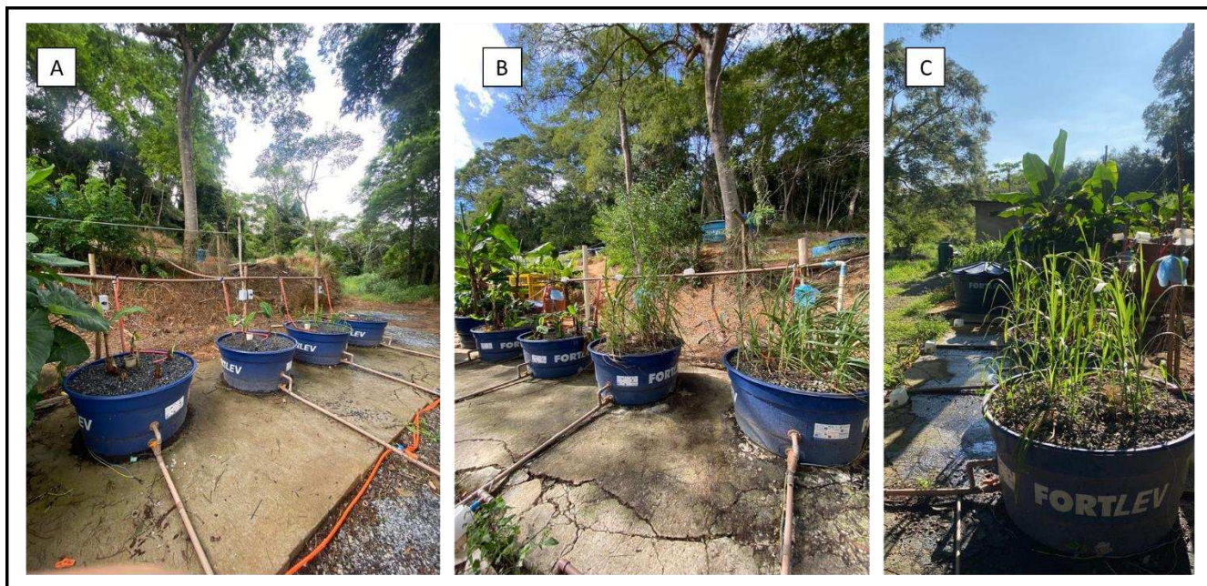
Figura 6: Sistemas Alagados Construídos com configuração do tidal flow. Fonte: Próprio autor (2023).
