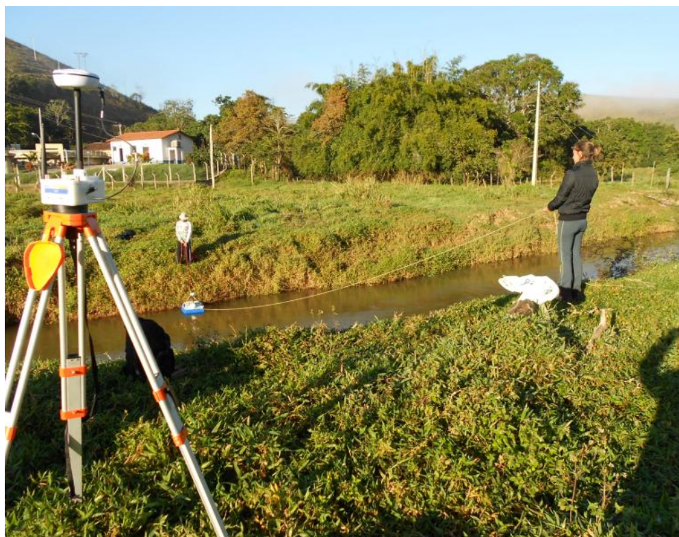
Figura 15 – Medição de vazão com o equipamento ADCP.
