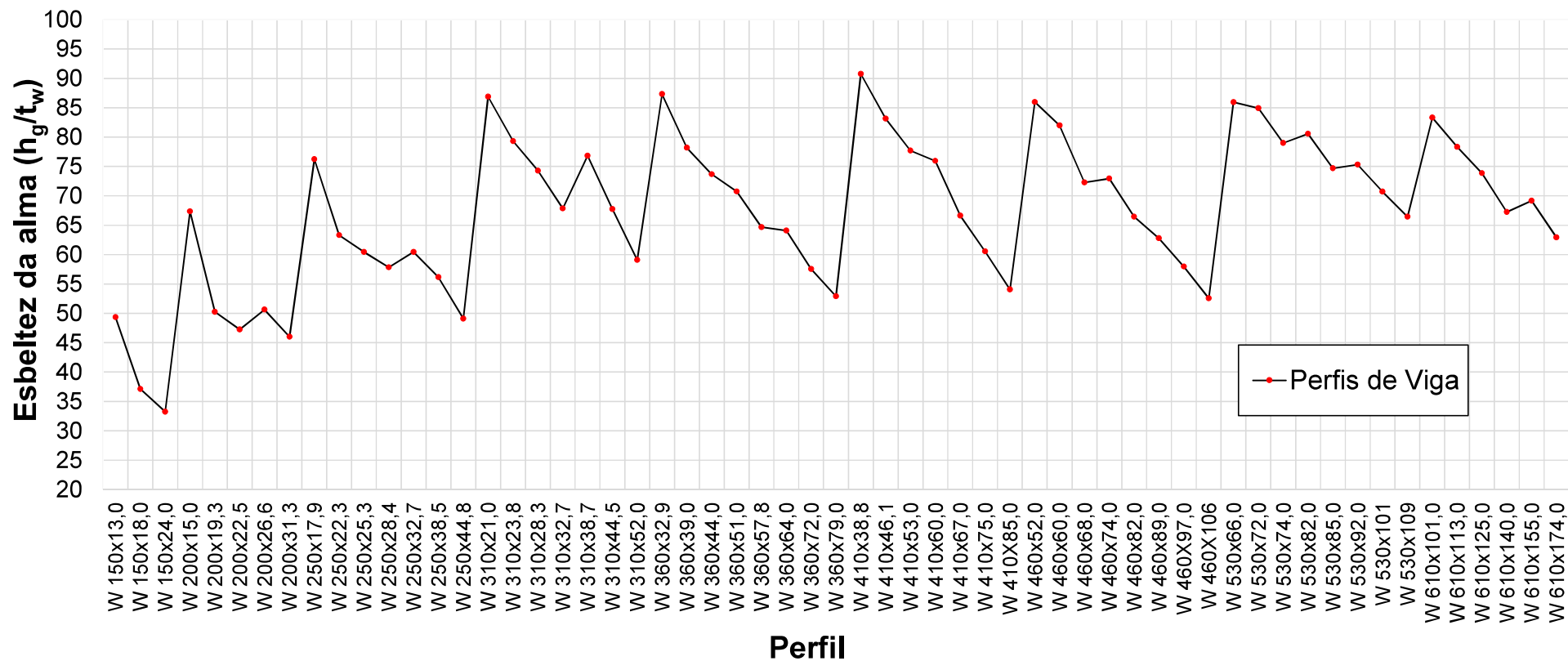
Figura 41 – Esbeltez da alma ( h_g/t_w ) dos perfis de viga do catálogo da GERDAU.
