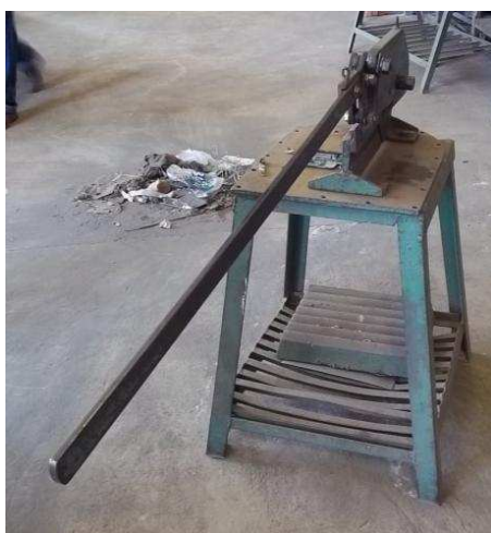
Figura 1. Guilhotina utilizada e amostra picada.
