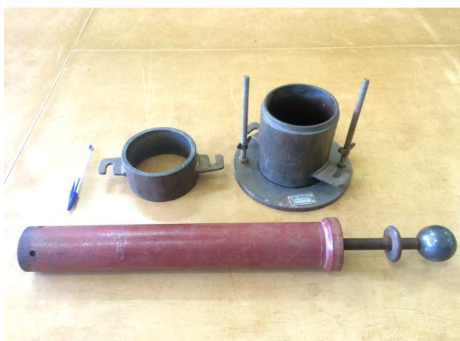
Figura 1 – Detalhes dos equipamentos utilizados no ensaio do Proctor Normal (colarinho, molde cilíndrico e soquete).
