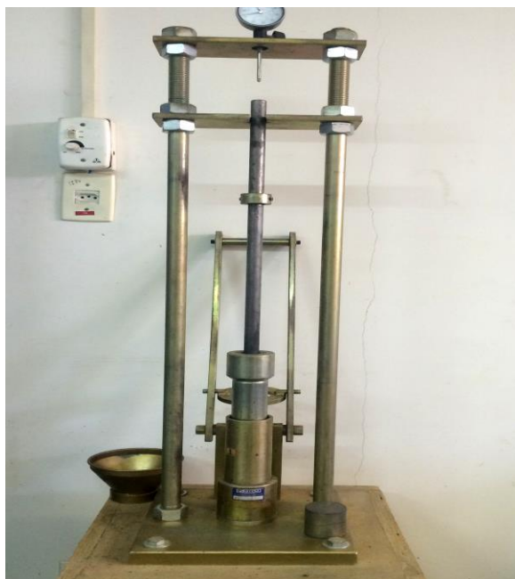
Figura 3: Equipamento utilizado no ensaio de compactação Mini-Proctor.
