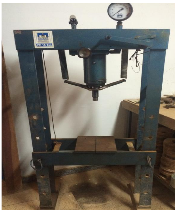
Figura 5 - Prensa hidráulica manual utilizada no presente estudo.
