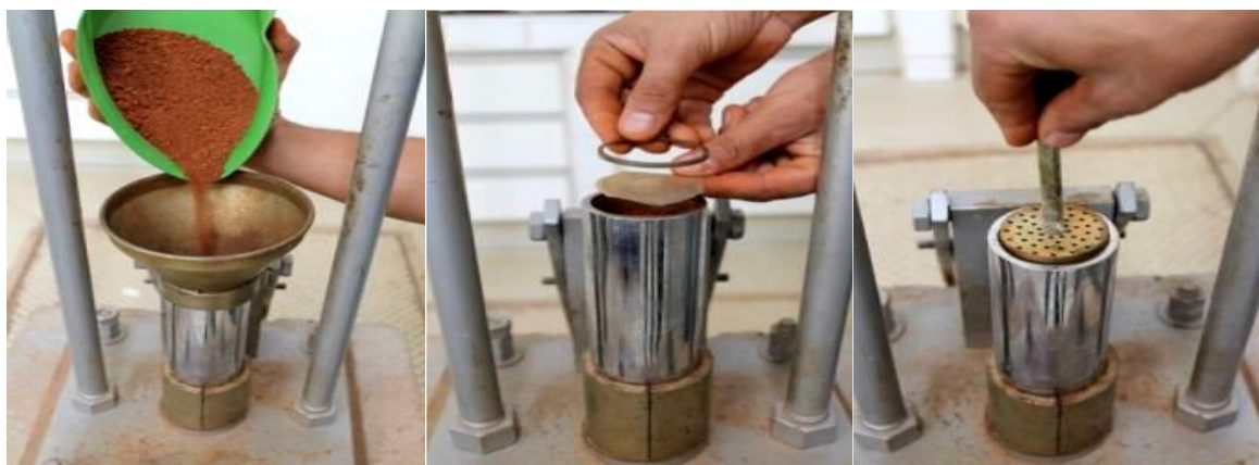
Figura 4 - Detalhes do processo de compactação do Ensaio Mini-Proctor.
