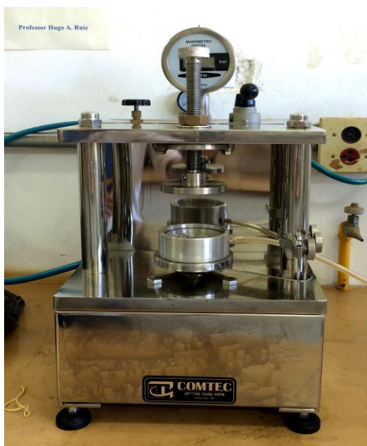
Figura 2 - Consolidômetro pneumático utilizado no ensaio de compressão uniaxial.
