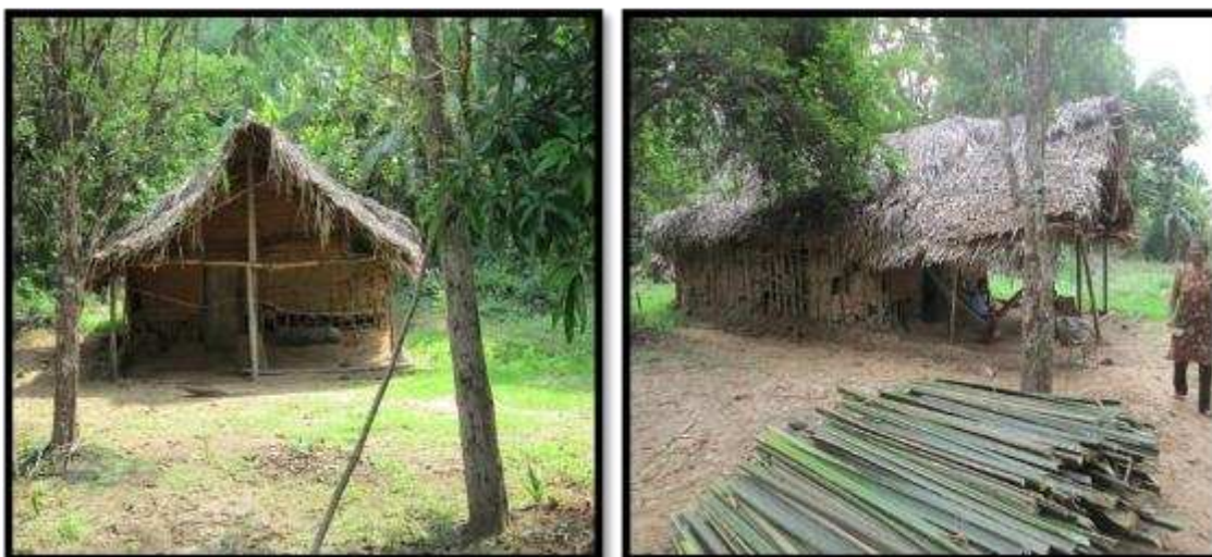
Figura 18 – Padrão construtivo de casa de taipa (Resex do Extremo Norte, 2014)
