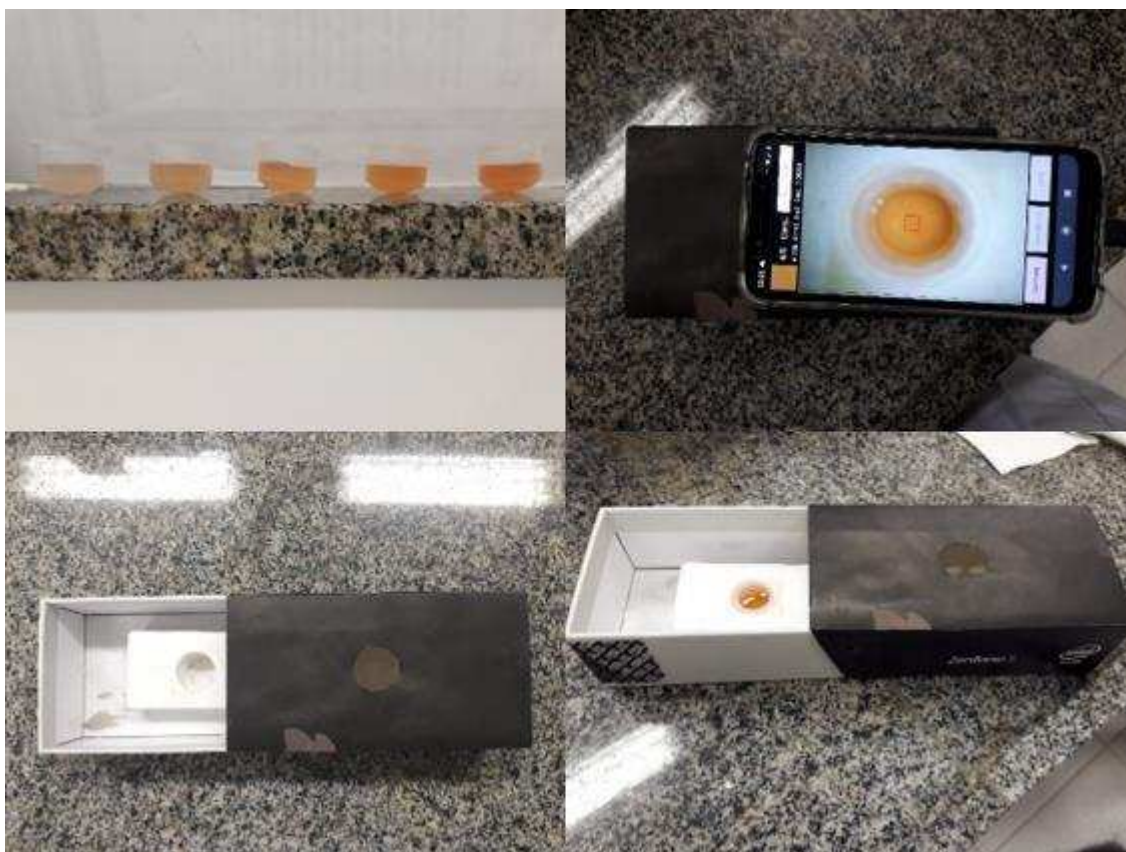
Figura 8: Sistema construído para a captura de imagem. Representação ilustrativa da câmara interior usadas para obtenção das imagens digitais
