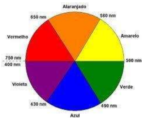
Figura 1: Disco de cores, com as cores complementares e intervalos de comprimento de onda
