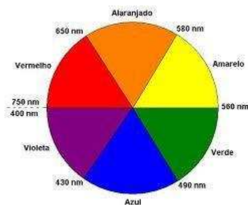
Figura 3: Diagrama esquemático que elucida as cores primárias e complementares no espectro eletromagnético do visível
