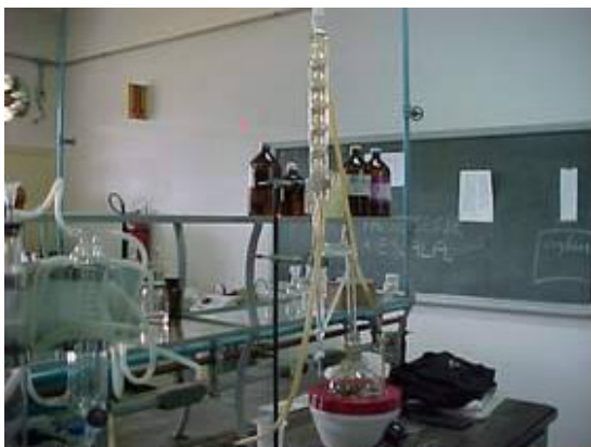
Figura 4- Equipamento empregado para extração do óleo essencial.
