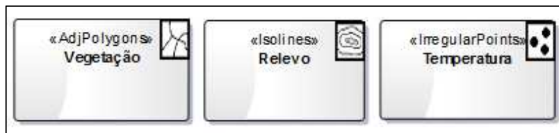
Figura 4.14: Esquema conceitual Meio Ambiente ilustrado a partir dos construtores da Tecnologia MDG_GeoProfile.
