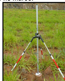
Figura 21: Processo de instalação do pino de centralização.
