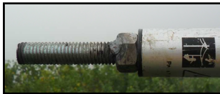
Figura 18: Processo de instalação do pino de centralização – ajuste do pino no bastão.
