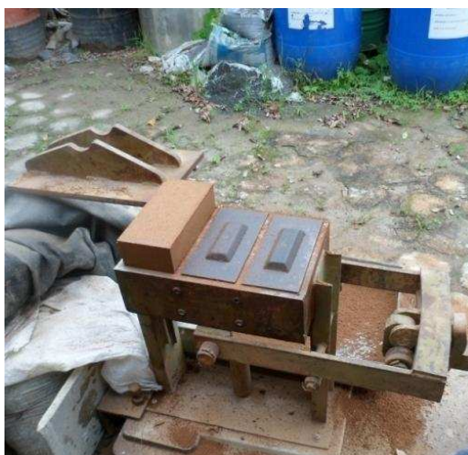
Figura 4.13 – Prensa manual utilizada para a fabricação dos tijolos maciços de solo-cimento-lodo.
