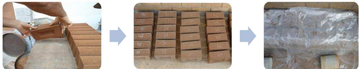
Figura 4.14 – Ilustração esquemática da produção dos tijolos de solo-cimento-odo.
