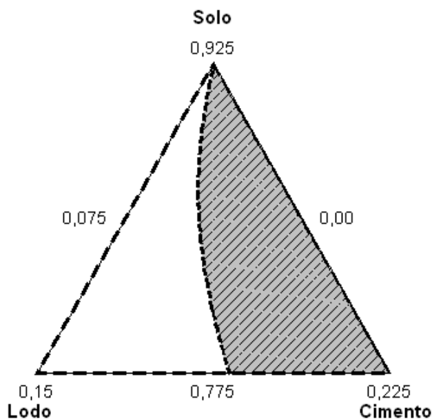
Figura 5.23 – Região experimental com representação das misturas solo-cimento-lodo para produção de tijolos que atendam ao limite mínimo de especificação para a resistência à compressão de acordo com a norma NBR 8492 (área hachurada).
