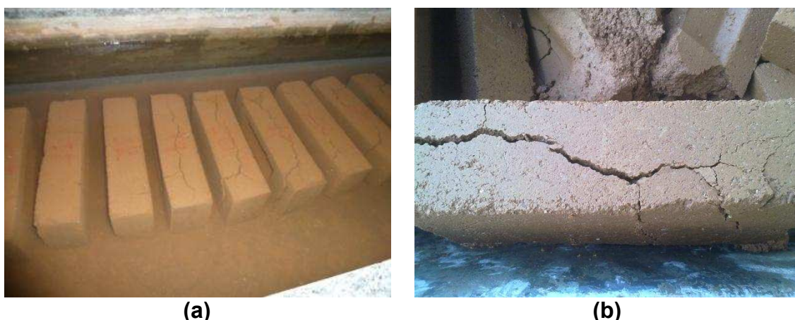
Figura 5.15 – Tijolos do traço 1 durante (a) e após (b) ensaio de absorção de água.
