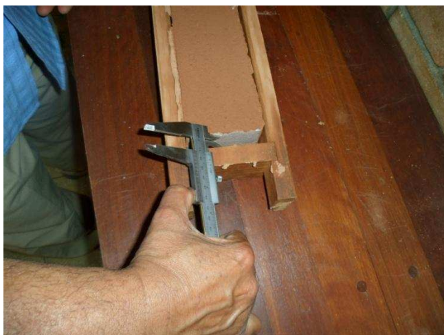
Figura 4.11 – Determinação da retração do corpo-de-prova no ensaio prático da caixa.
