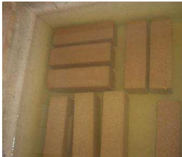
Figura 4.15 – Tijolos imersos em água para determinação da absorção de água segundo método da NBR 8492 (ABNT, 2012).
