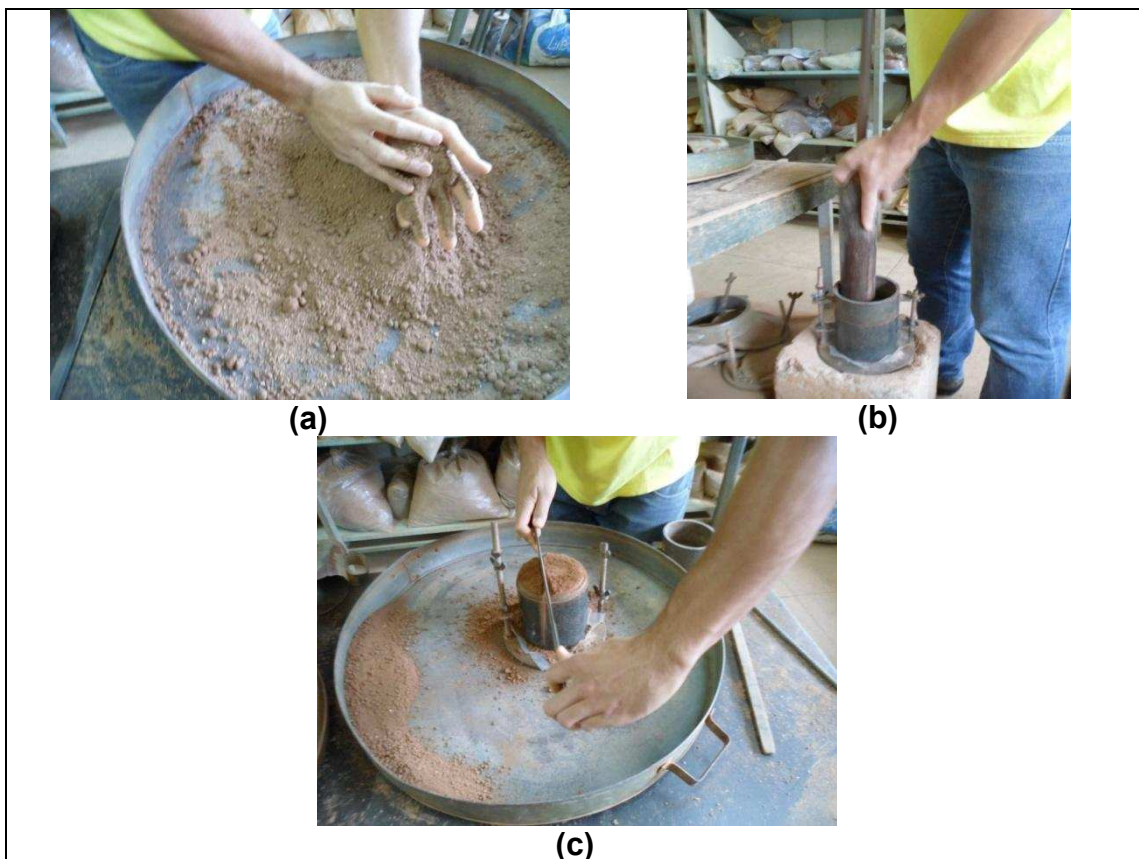
Figura 4.12 – Detalhes das etapas do ensaio de compactação para determinação da umidade ótima: homogeneização manual da amostra (a); compactação das camadas no molde cilíndrico com uso de soquete padrão (b); rasadura do corpo-de-prova (c) para pesagem e determinação da massa específica seca.
