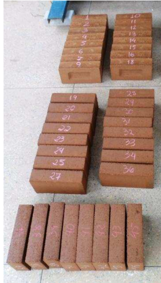
Figura 5.13 – Tijolos produzidos para avaliar o efeito do teor de umidade sobre as propriedades dos tijolos de solo-cimento com incorporação de lodo de ETA (traço 1).
