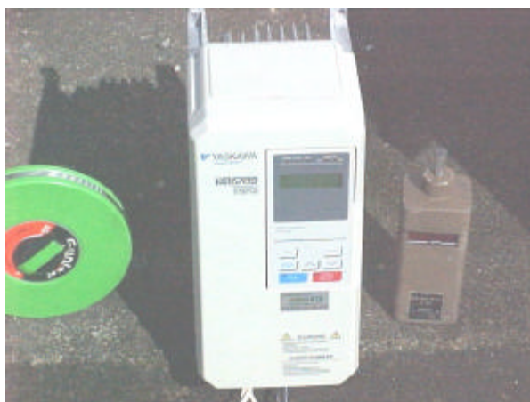
Figura 5.2. Vista de alguns equipamentos de medição: trena, inversor de frequência e tacômetro.
