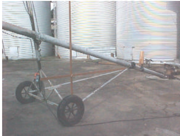
Figura 5.4. Medição da inclinação do transportador helicoidal.
