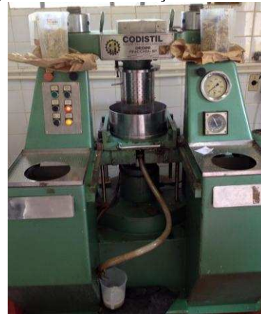
Figura 2.8 Extração do caldo por meio de prensa
