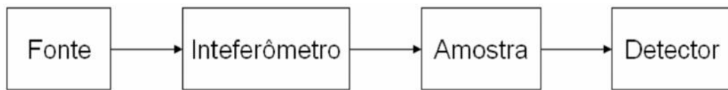
Figura 6 - Esquema simplificado de um equipamento de FT-IR.
