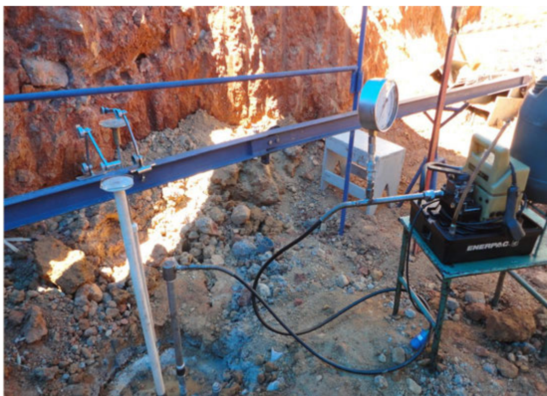
Figura 13 - Esquema de montagem do sistema de carga na superfície.
