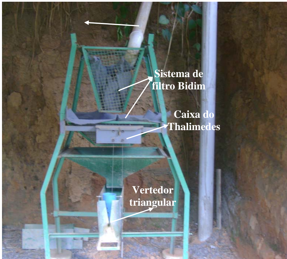
Figura 3.2. Estrutura de coleta das perdas de solo e de água e monitoramento do escoamento superficial.
