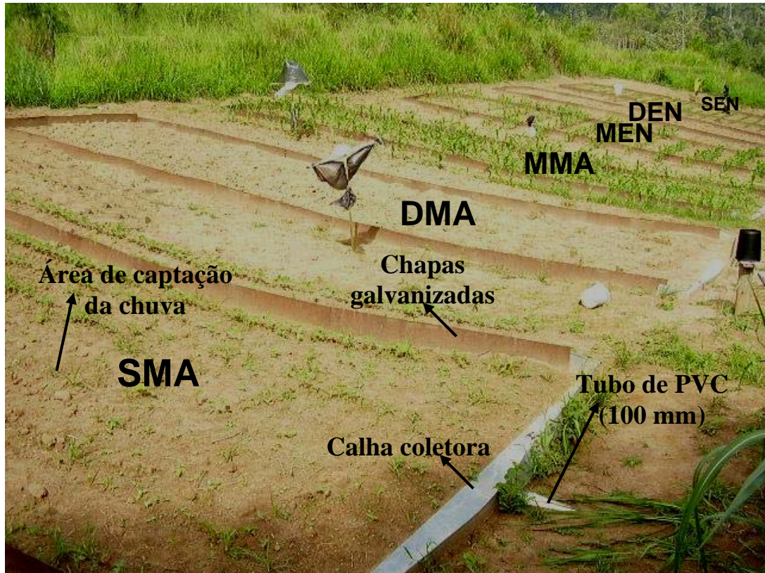
Figura 3.1. Parcelas experimentais para monitoramento das perdas de solo e de água sob condições de chuva artificial.
