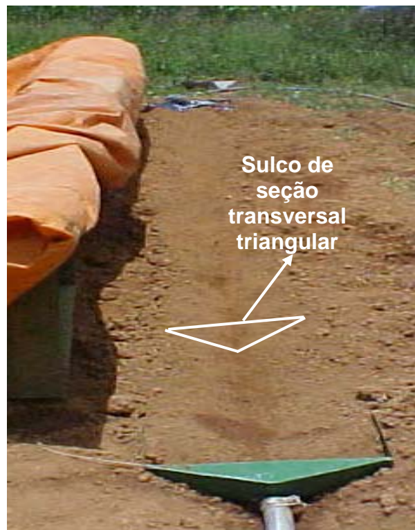
Figura 3.12. Sulco construído no sentido do declive em solo recém-preparado com a finalidade de determinação da erodibilidade no sulco ( K_r ) e da tensão cisalhante crítica do solo ( \tau_c ).
