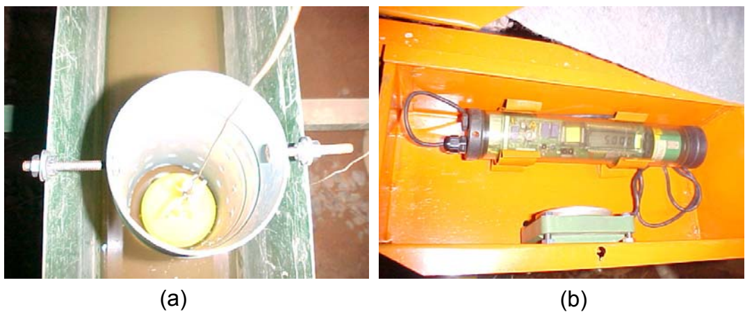
Figura 3.3. Detalhes da altura de lâmina vertente obtida por meio do sensor de nível (a) do equipamento Thalimedes (b).
