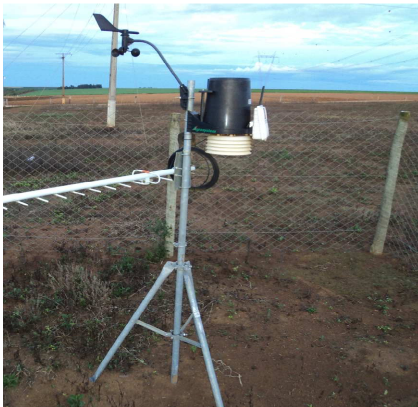
Figura 3. Estação meteorológica automática
