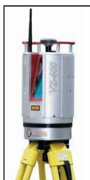
Figura 4.4 – Laser Scanner terrestre modelo VZ-400, da RIEGL
