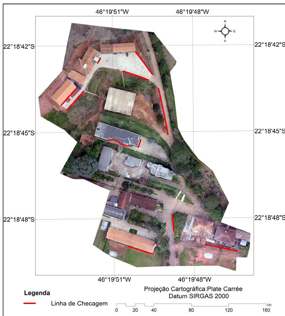
Figura 2.3 – Método das feições lineares aplicadas ao processo de avaliação da acurácia posicional da ortofoto do VANT
