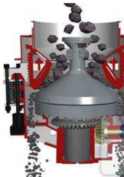
Figura 2.5 - Detalhe do funcionamento do britador cônico ( http://www.sbmmine.com - 2015)
