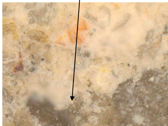
Figura 4.30 - Concreto com RMT, AGN e fibra -200x
