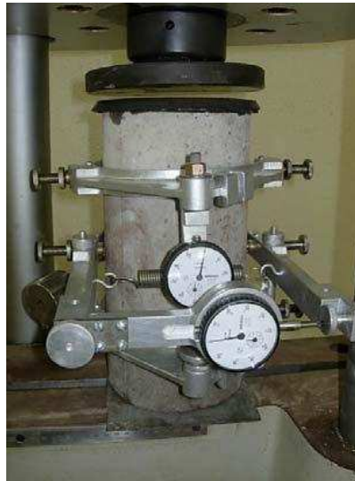
Figura 3.5 – Corpos de prova instrumentados para ensaio de módulo de elasticidade e coeficiente de Poisson.
