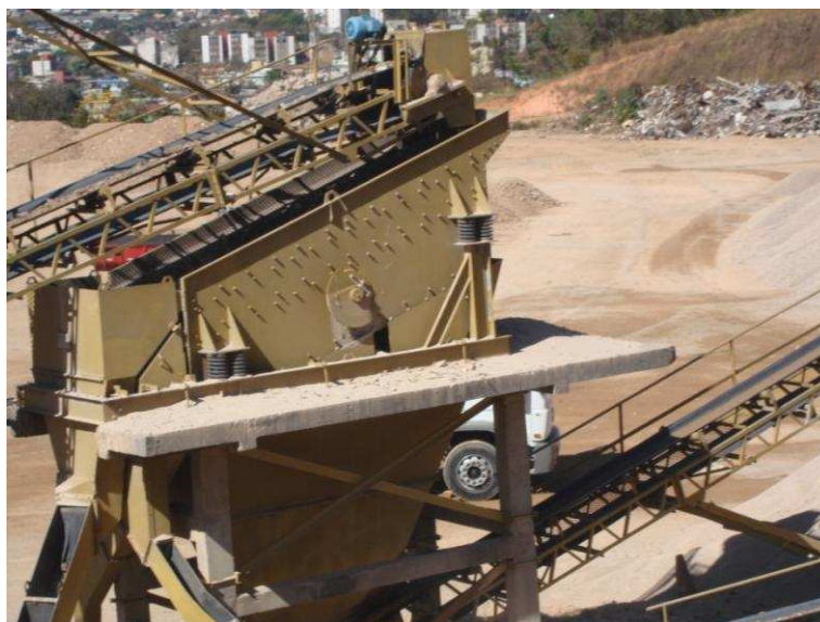
Figura 2.6 – Peneira vibratória da Usina de Belo Horizonte - 2013.
