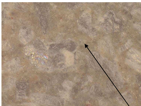
Figura 4.31 - Concreto com RMT, RCD e fibra -50x
