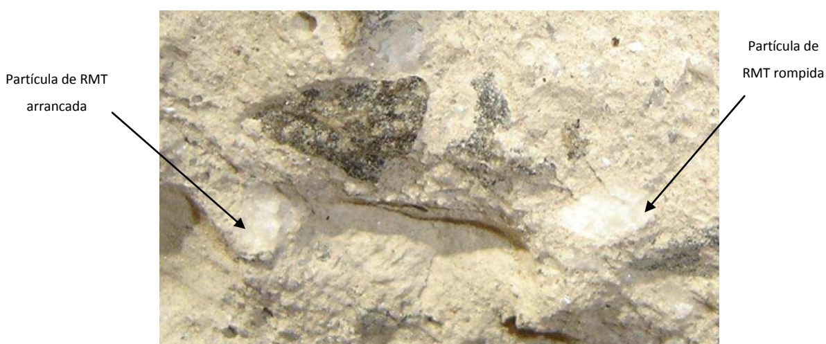
Figura 4.6 – Corpo-de-prova com RMT
