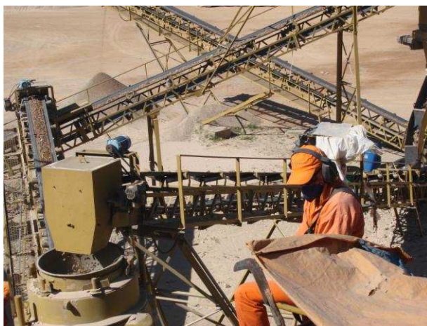
Figura 2.10 - Área destinada à catação manual e separação magnética dos agregados reciclados na usina de Belo Horizonte - 2013.
