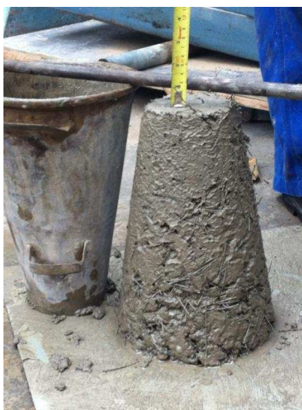
Figura 4.1 – Abatimento da mistura com RCD rejeito de mármore e fibra (S = 40 mm).
