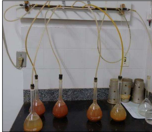
Figura 32 - Parte da execução do ensaio de determinação da massa específica dos sólidos.
