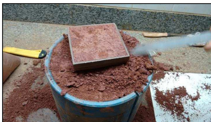
Figura 29 - Corpo de prova sendo extraído da amostra indeformada do solo.
