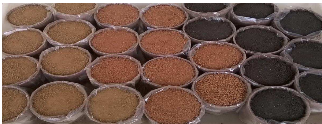
Figura 2. Vasos contendo amostras dos solos preparadas para receberem a irrigação e aplicação do herbicida para estudo da meia-vida da mistura diuron + hexazinone no solo
