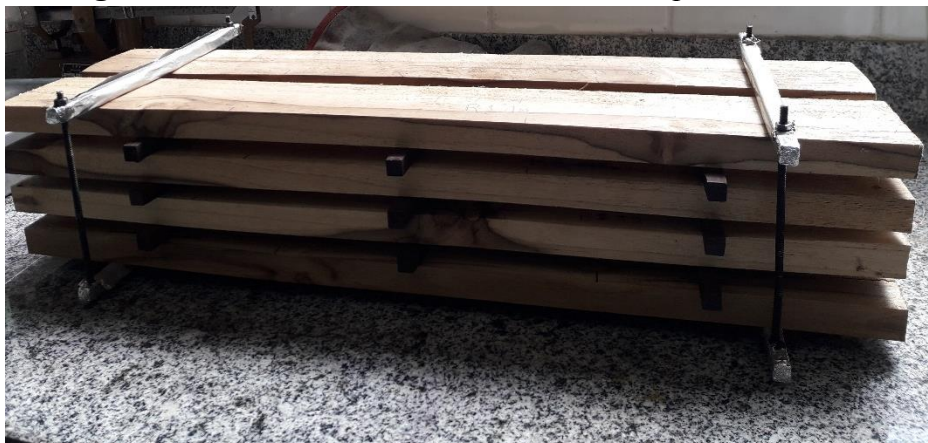
Figura 3. Madeiras entabecadas e fixadas no suporte de ferro.
