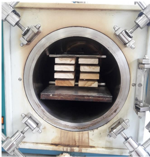
Figura 3. Madeiras entabecadas e fixadas no suporte de ferro.
