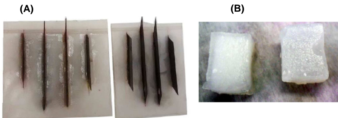
Figura 4.1. (A) Dispositivos home-made utilizados para o corte dos cubos de ágar-ágar, espaçamento de 2,0 cm e espaçamento de 1,0 cm. (B) Pellets obtidos após corte da matriz de ágar-ágar utilizando dispositivos home-made.
