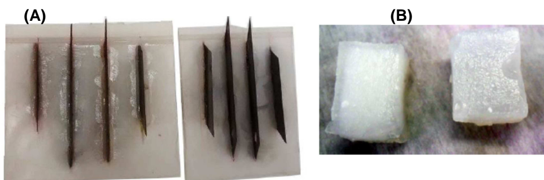
Figura 2.1 – (A) Dispositivos “home-made” utilizados para o corte dos cubos de ágar-ágar, espaçamento de 2,0 cm e espaçamento de 1,0 cm. (B) Pellets obtidos após corte da matriz de ágar-ágar utilizando dispositivos “home-made”.
