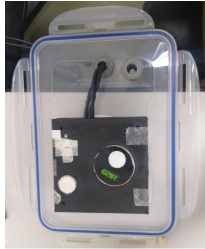
Figura 3 - (A) recipiente com os grãos de trigo e (B) a case com os sensores fixados na tampa do recipiente
