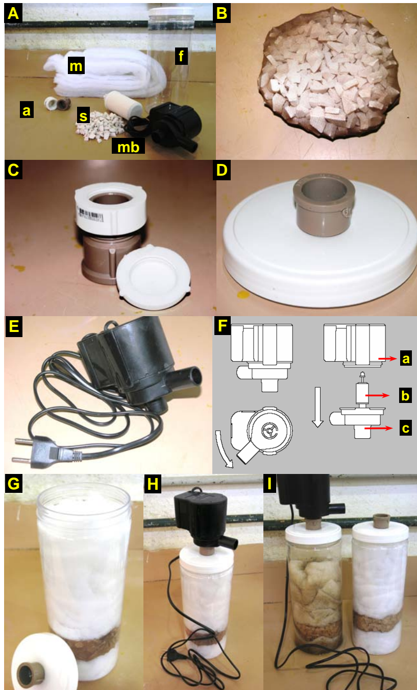
Figura 2. Detalhes da montagem do sistema moto-bomba submersa e pré-filtro: m – manta acrílica (material filtrante); f – frasco cilíndrico com tampa rosqueada; mb – moto-bomba submersa; s – substrato (vela cerâmica fragmentada de filtro de água doméstico) para filtração biológica; a – adaptador misto 25 mm/ 3/4” com porca de PVC; B – saco de nylon contendo substrato para fixação de bactérias (filtração biológica); C – detalhe do adaptador misto de PVC com a porca obtida a partir de um tampão (“cap”) de PVC de 3/4” serrado. D – Tampa do frasco perfurada com o adaptador instalado. E e F – moto-bomba submersa com detalhes das partes componentes: a – indutor; b – conjunto impulsor (“impeller”); c – voluta; G – pré-filtro contendo os elementos filtrantes em camadas; H – conjunto moto-bomba e pré-filtro montado; I – comparação entre um pré-filtro usado (esquerda, coloração escura) com destaque à retenção de resíduos, e outro, sem uso (à direita, sem a moto-bomba).
