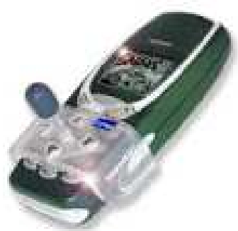
Figura 4.17: Primeiro Joystick como acessório para celular [25]
