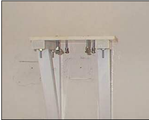
Figura 4.7 – Base da caixa receptora com seus 4 parafusos niveladores.
