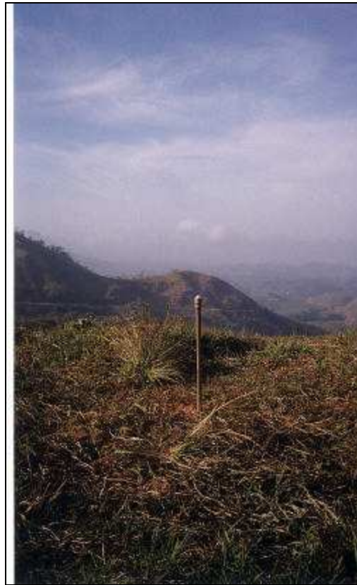
Figura 3.10 – Piezômetro instalado na Serra de São Geraldo.
