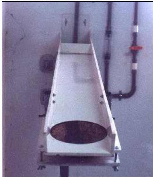
Figura 4.13 – Amostra de solo devidamente instalada para execução do ensaio Inderbitzen.
