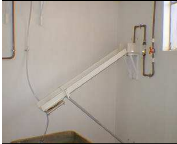
Figura 4.5 – Vista da rampa, do rotâmetro e do registro regulador da vazão de saída.
