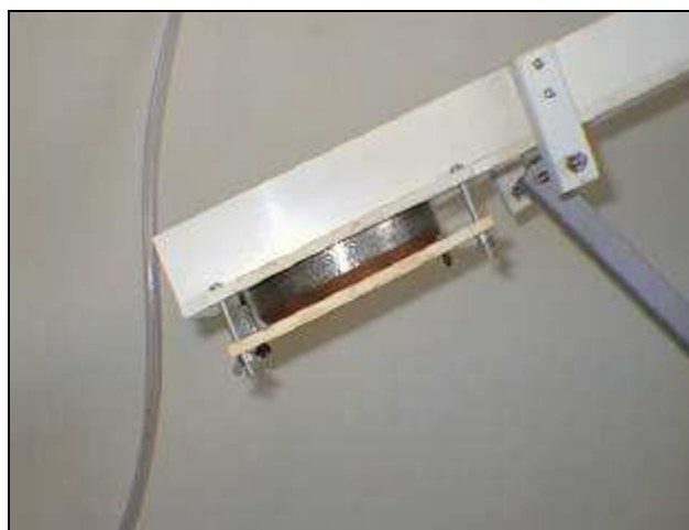
Figura 4.12 – Visão lateral do anel amostrador devidamente acoplado na rampa através de quatro parafusos.
