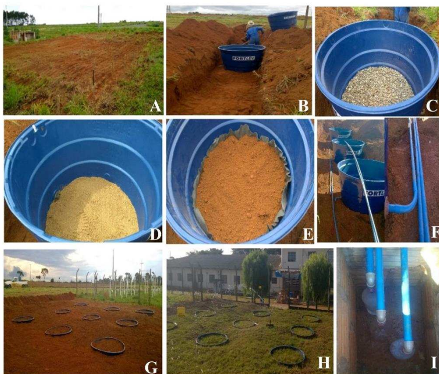
Figura 1. Montagem das unidades experimentais: A) Vista geral do local do experimento; B) Detalhe da instalação das caixas na valeta; C) Camada de brita ao fundo; D) Camada de areia sobre a brita; E) Início da reconstituição das camadas de solo no lisímetro; F) Detalhe dos tubos de drenagem G) Visão geral ao final da montagem; H) Visão geral dos lisímetros após a implantação da forrageira; I) Detalhe dos coletores de lixiviado nas caixas de observação.
