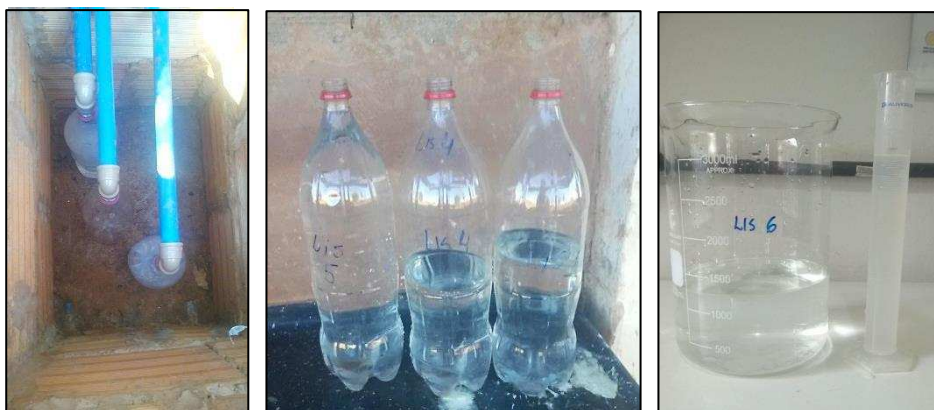
Figura 3. Detalhe dos coletores de lixiviado no fosso, do aspecto do material coletado e retirada da alíquota.
