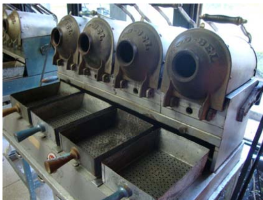
Figura 1: Torrefador de quatro cilindros rotativos com queima de gás direto.
