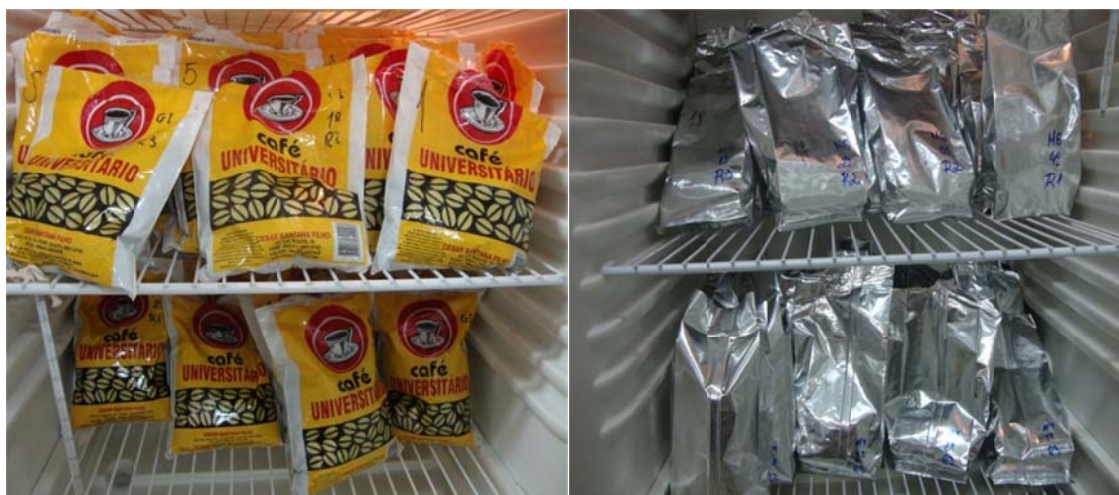
Figura 1: Dois tipos embalagens contendo café torrado em diferentes níveis granulométricos, armazenados em câmara tipo BOD na temperatura de 25 °C por 120 dias.
