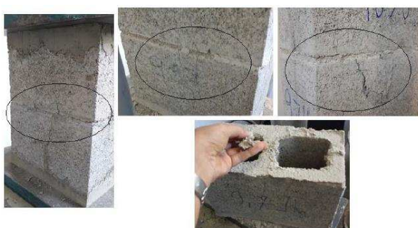
Figura 4-12- Modo de ruptura do prisma- Série 1. Fonte: Castro (2015).
