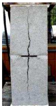
Figura 4-15- Modo de ruptura para prismas feitos com argamassamento parcial.
