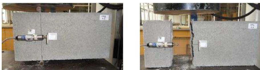
Figura 4-3- Ensaio de resistência à tração indireta dos blocos de concreto.
