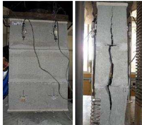
Figura 4-5- Modo de ruptura de prismas de blocos de concreto. Fonte: Oliveira (2014)
