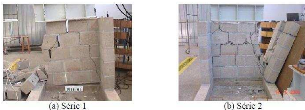
Figura 2-23 –Tipos de ruptura – Escala natural Fonte: Maurício (2005).
