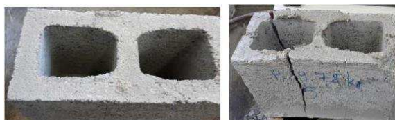
Figura 4-14- Modo de ruptura do prisma, utilizando-se argamassa A3.
