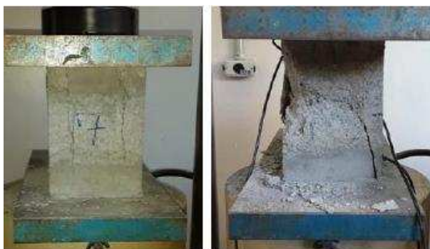
Figura 4-11- Modos de ruptura do bloco, a) fissura vertical e b) tronco cônica. Fonte: Castro (2015).
