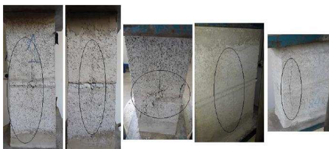
Figura 4-13- Modos de ruptura dos prismas, utilizando argamassa A2. Fonte: Castro (2015).
