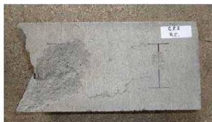
Figura 4-2- Modo de ruptura das unidades de concreto.
