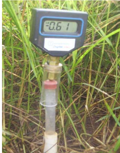
Figura 15 – Tensiômetro digital registrando potencial matricial de -61 kPa.
