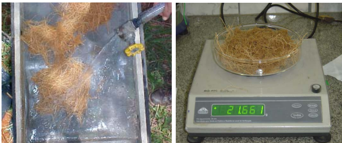
Figura 22 – Limpeza de raízes com água corrente e pesagem em balança de precisão após secagem.
