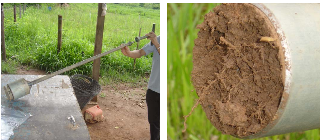
Figura 20 – Trado cilíndrico de aço usado para retirada das amostras com material de solo e raízes.
