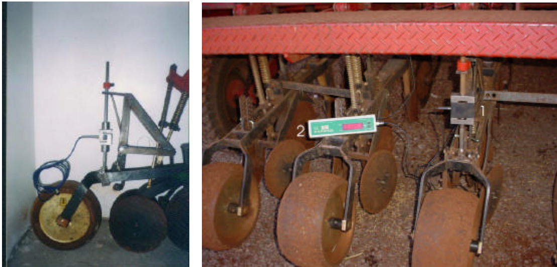
Figura 5 – Vista geral dos equipamentos utilizados na determinação das cargas aplicadas no solo pela roda compactadora. (1) célula de carga e (2) visor.
