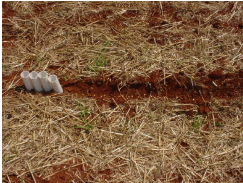
Figura 9 – Vista geral dos cilindros plásticos utilizados para retirada das amostras indeformadas, para determinação da densidade do solo na região da semente.
