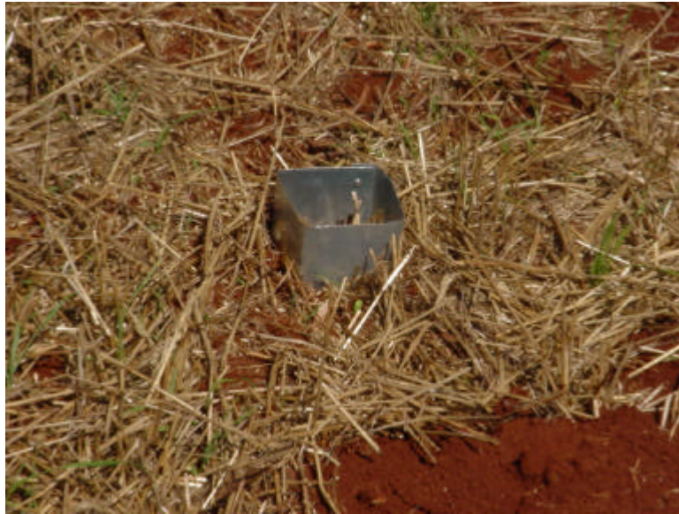
Figura 7 – Vista geral da caixa metálica utilizada para determinação do diâmetro médio ponderado.
