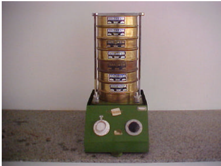
Figura 8 – Agitador mecânico utilizado no peneiramento das amostras de solo.
