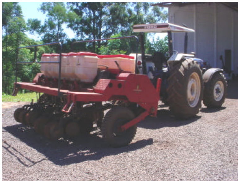
Figura 4 – Semeadora-adubadora PSMT 6414 da Vence Tudo com cinco linhas para soja, utilizada no experimento de campo.
