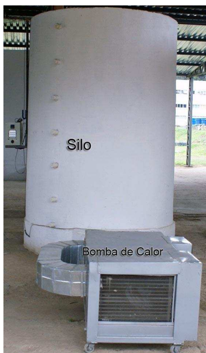
Figura 4.1 - Bomba de calor acoplada ao silo.
