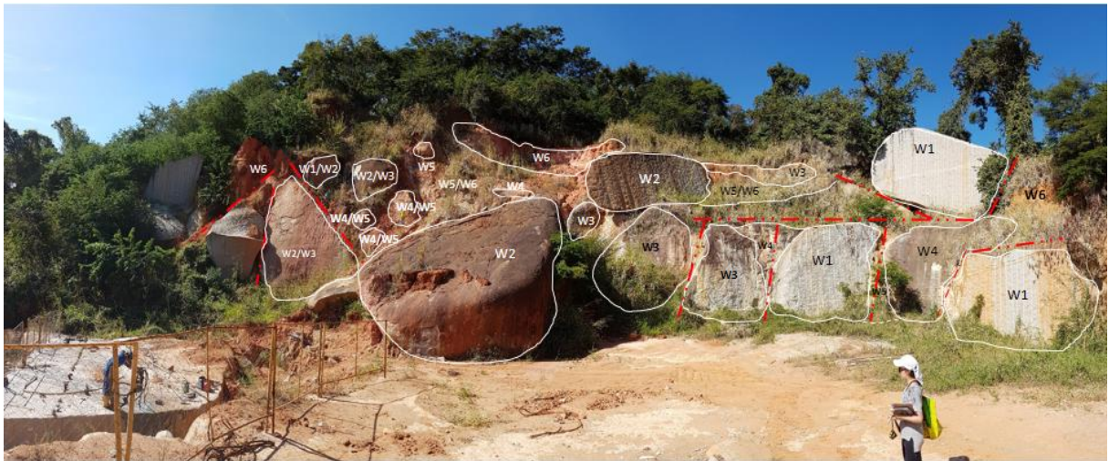
Figura 5 - Aspecto geral do perfil 2, com delimitações quanto ao grau de intemperismo (linhas brancas) e demarcações das descontinuidades (linhas vermelhas).
