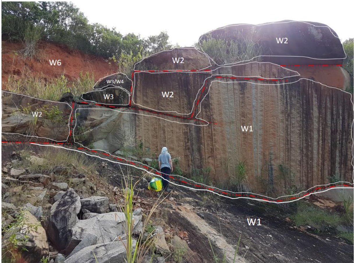
Figura 4 - Aspecto geral do perfil 1, com delimitações quanto ao grau de intemperismo (linhas brancas) e demarcações das discontinuidades (linhas vermelhas).
