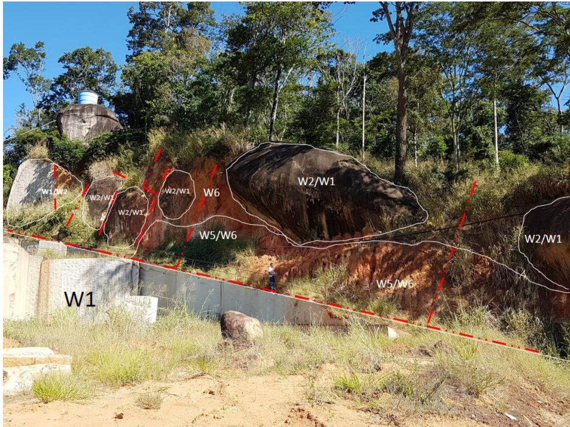
Figura 6 - Aspecto geral do perfil 3, com delimitações quanto ao grau de intemperismo (linhas brancas) e demarcações das descontinuidades (linhas vermelhas).
