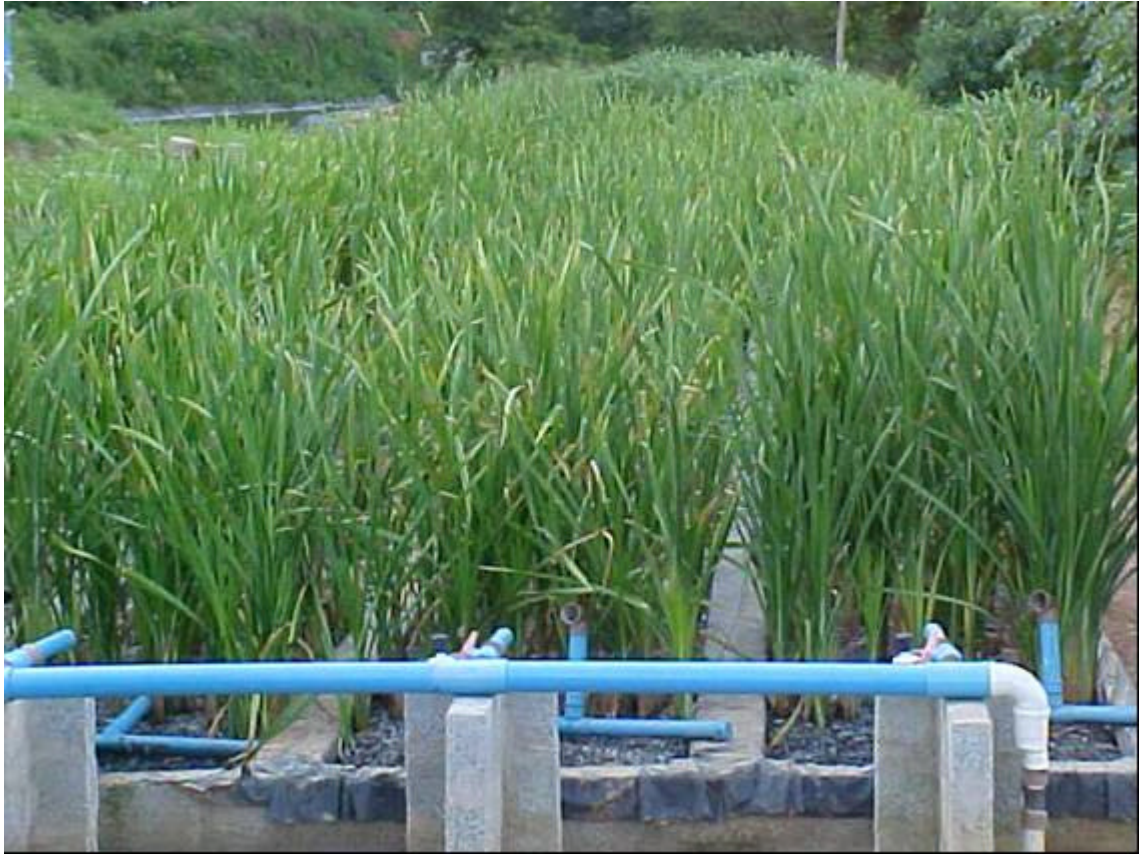
Figura 9 - Detalhe do estande de macrófita aos 39 dias após o corte raso das plantas.
