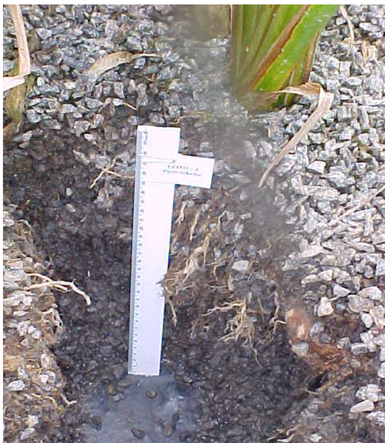
Figura 12 - Detalhe da profundidade e densidade de raízes da Typha sp . em SAC.
