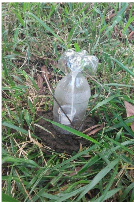
Figura 3 - Câmara estática semi-aberta utilizada para quantificação da volatilização de \text{NH}_3 .
