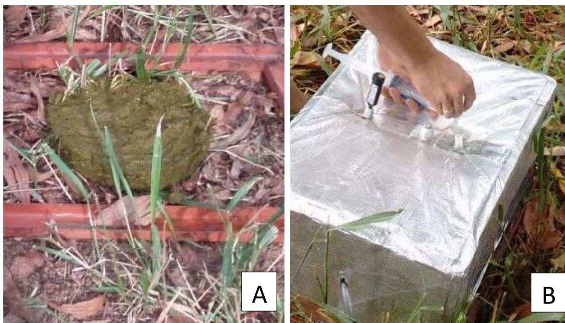
Figura 2 - Base metálica (A) e topo (B), que formam a câmara estática usada para quantificação dos fluxos de N_2O e CH_4 .
