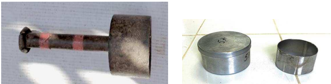
Figura 11 – Trado tipo castelinho, cápsula de alumínio e anel volumétrico utilizados na coleta de amostras indeformadas
