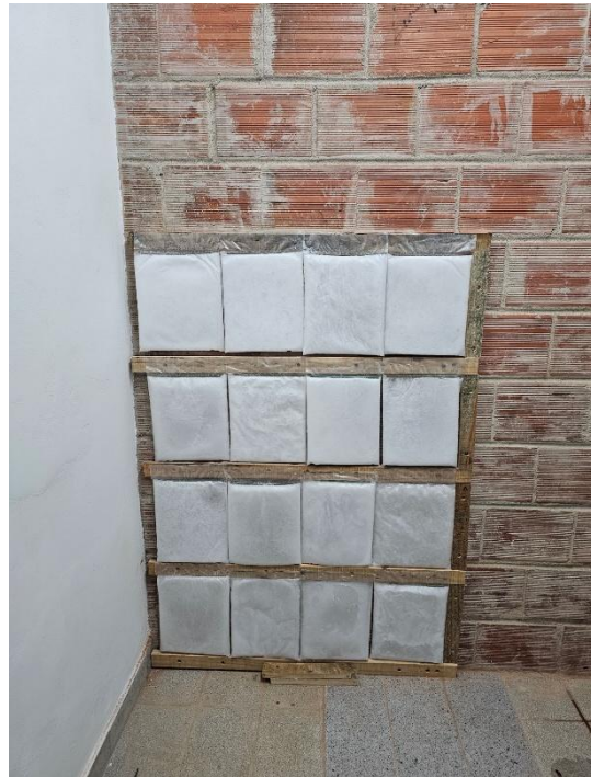
Célula Teste – Fixação invólucro PCM
