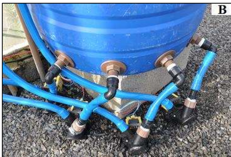
Figura 3.2. Reservatório plástico com capacidade para 120 L (A), para preparo e armazenamento da solução nutritiva. Disposição das quatro motobombas (B), com potência individual de 32 W, na parte inferior do reservatório, as quais foram acionadas para realização dos eventos de irrigação ou de fertirrigação durante o período experimental.
