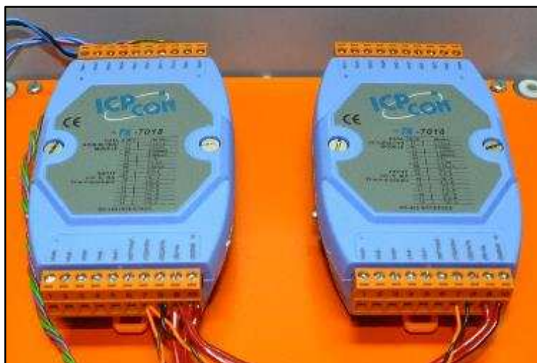
Figura 3.5. Módulos seriais de aquisição de dados utilizados na conversão analógico-digital dos sinais dos sensores utilizados na medição dos elementos meteorológicos no ambiente de cultivo da cana-de-açúcar.
