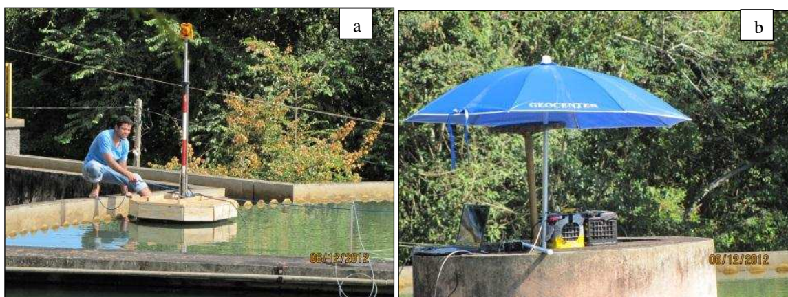
Figura 4.4 – Suporte para adaptar o transdutor e prisma (Figura 4.4-a). Demais equipamentos (baterias e computador) na Figura 4.4-b.
