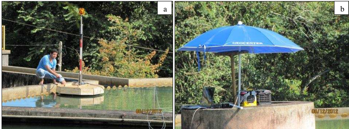
Figura 3.2 – Suporte para adaptar o transdutor e prisma (Figura 3.2-a). Demais equipamentos (baterias e computador) na Figura 3.2-b.
