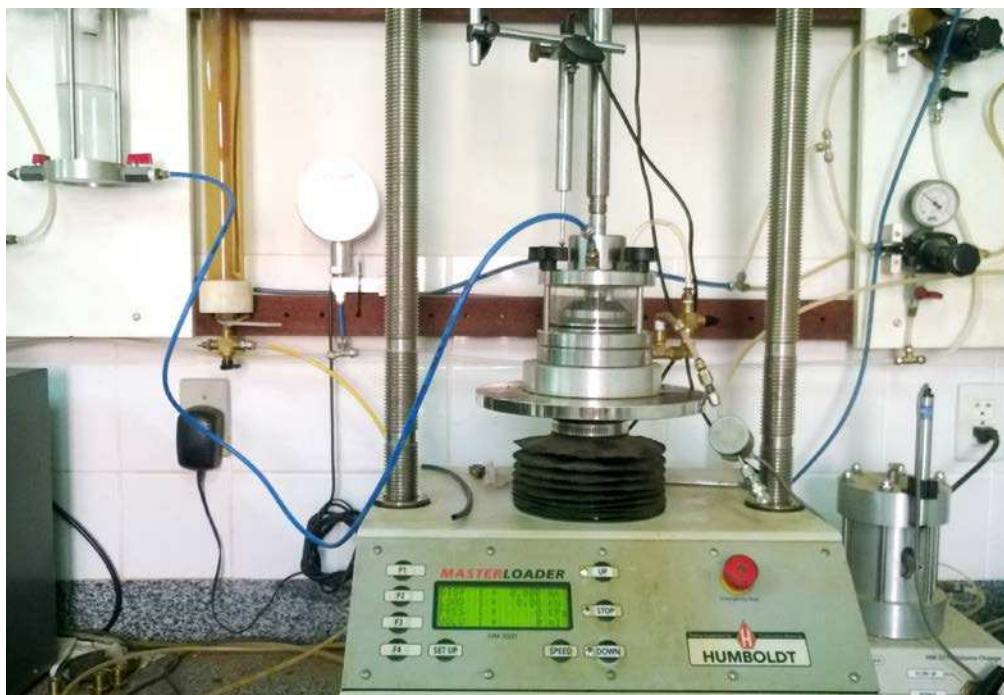
Figura 10. Visão geral do equipamento utilizado no ensaio de adensamento CRD.
