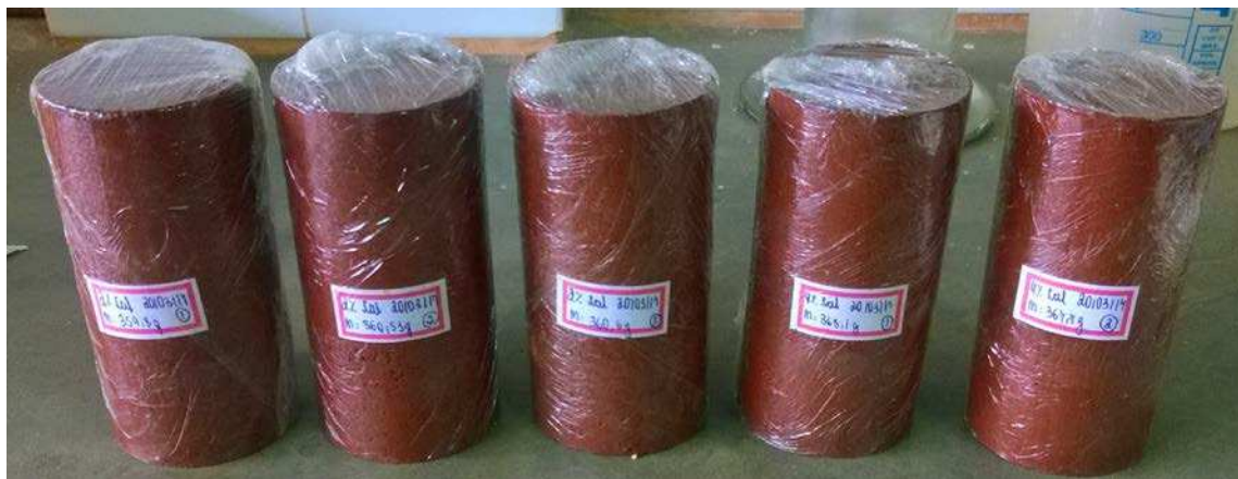
Figura 8. Corpos de prova dos ensaios de compressão não confinada.
