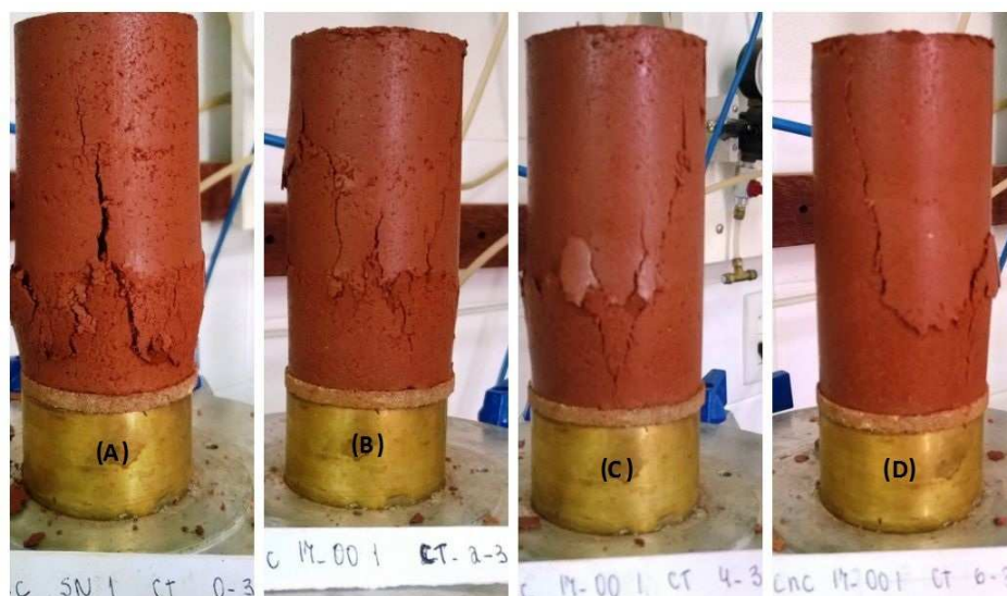
Figura 14. . Corpos de prova ensaiados com 3 dias de cura: (A) solo natural; (B) solo + 2% de cal; (C) solo + 4% de cal; e (D) solo + 6% de cal.
