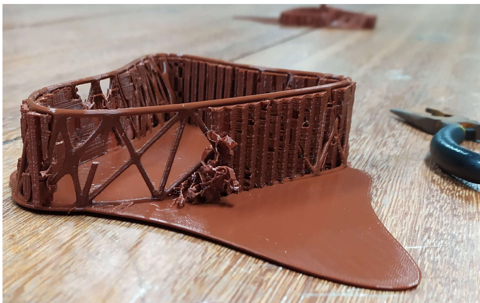
Figura 21 – Torre 1: Retirada manual de suportes.
