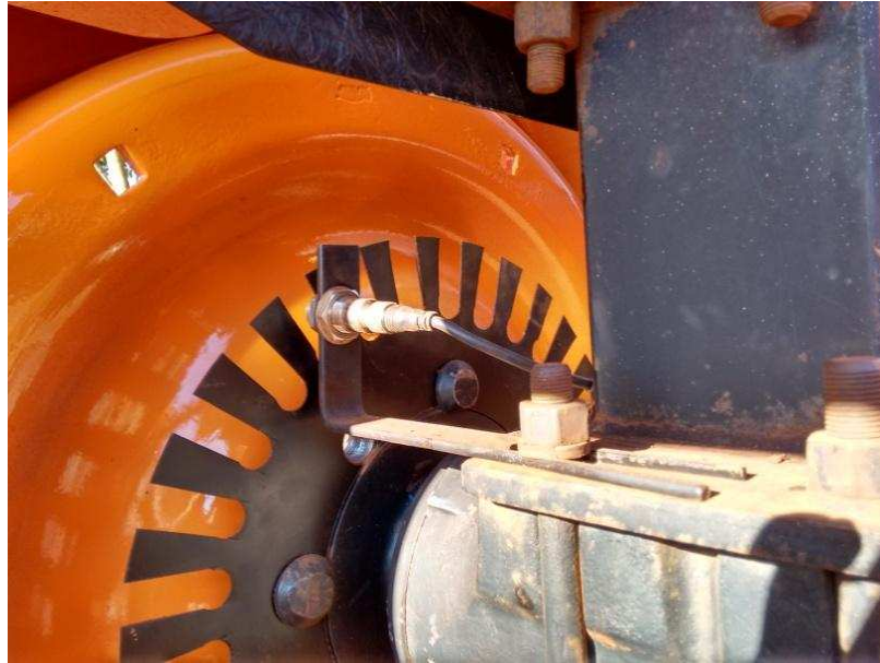
Figura 14. Sensor indutivo para determinação da velocidade angular dos rodados do Transformax®.
