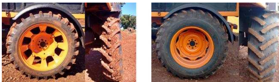
Figura 10. Pneus avaliados no desempenho do Transformax®: a) 13.6-38 e b) 18.4-34.
