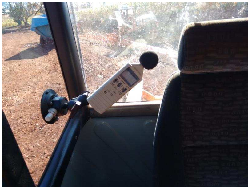
Figura 17. Posicionamento do decibelímetro no posto de operação do trator.
