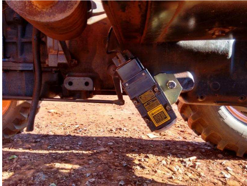
Figura 13. Radar utilizado para medição da velocidade instantânea do Transformax ® .
