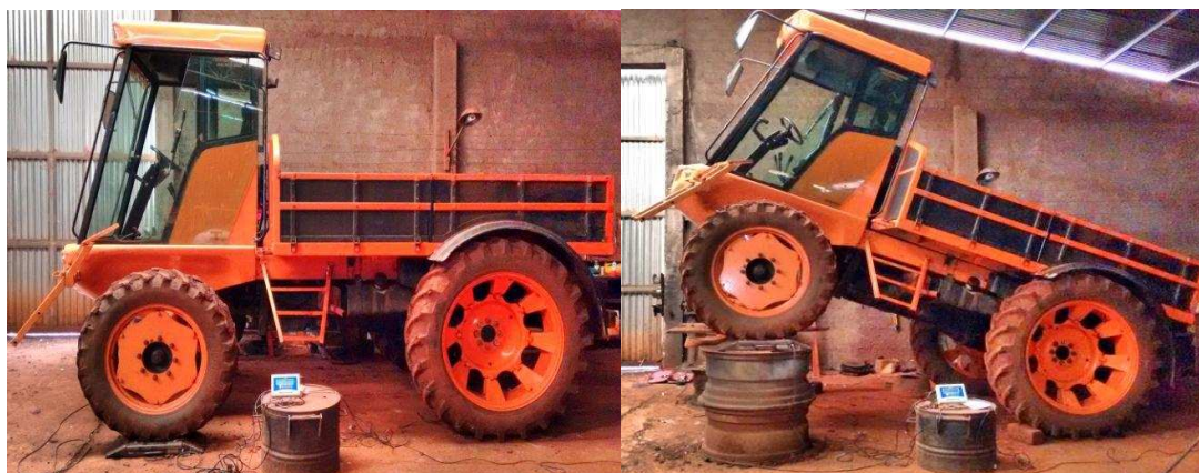
Figura 7. Determinação do centro de gravidade do Transformax ® pelo método da pesagem.
