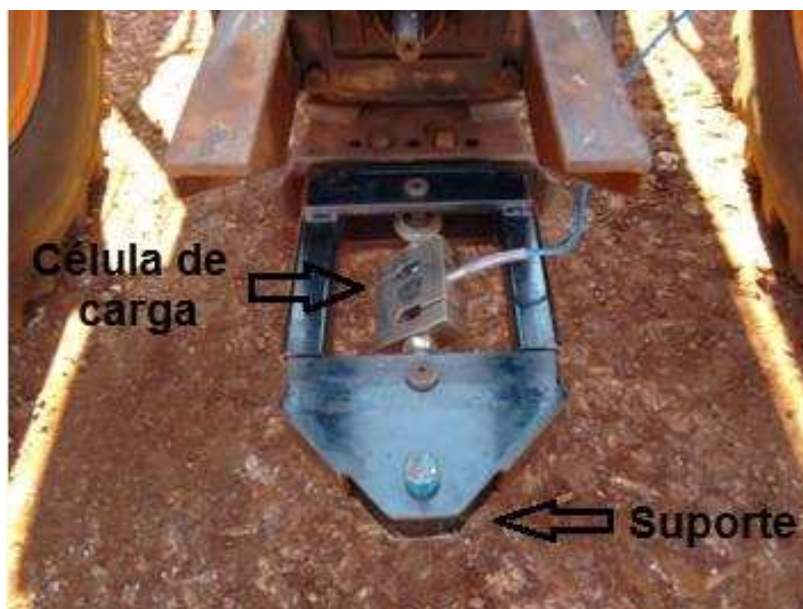
Figura 12. Célula de carga e estrutura suporte para a instalação no trator
