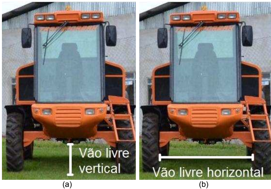
Figura 3. Medição do vão livre vertical (a) e vão livre horizontal (b)
