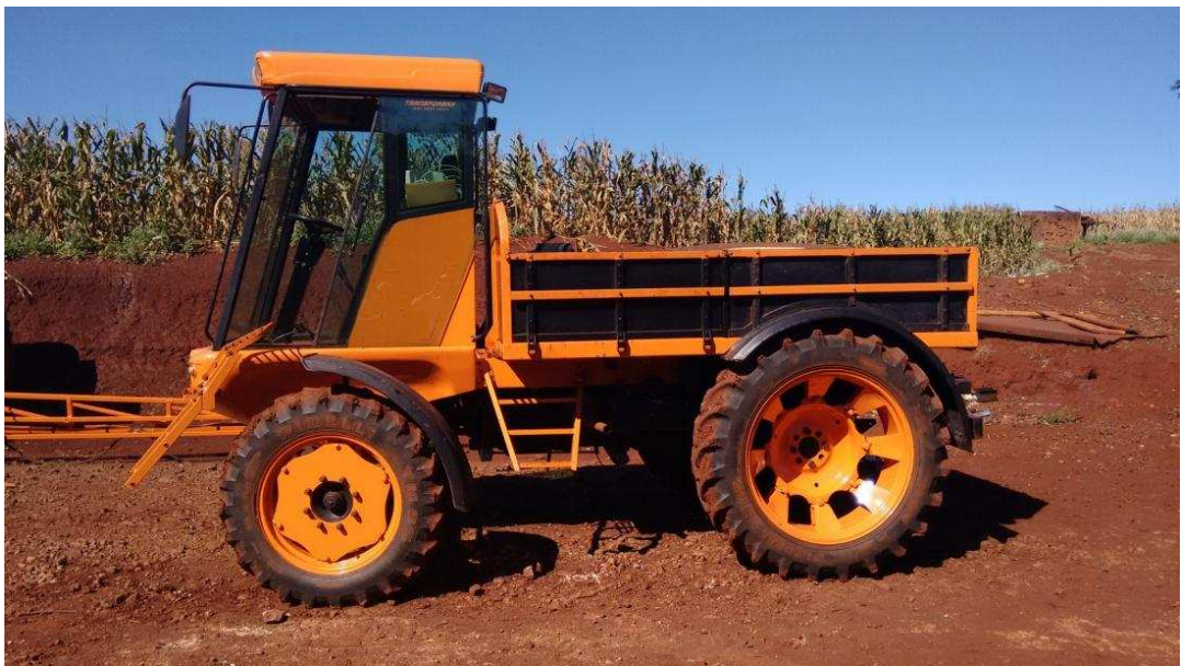
Figura 2. Transformax ® configuração trator agrícola.
