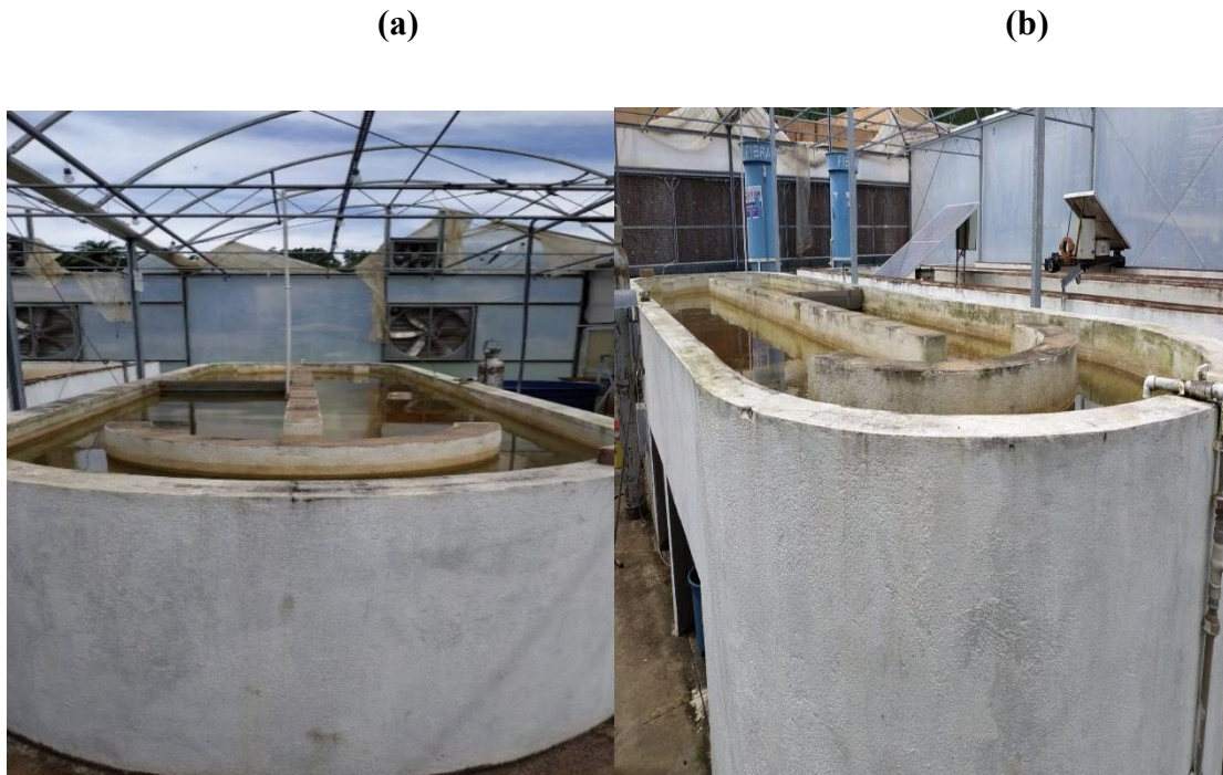
Figura 2 – Tanque de produção da biomassa microalgal: a) vista frontal, b) vista lateral.
