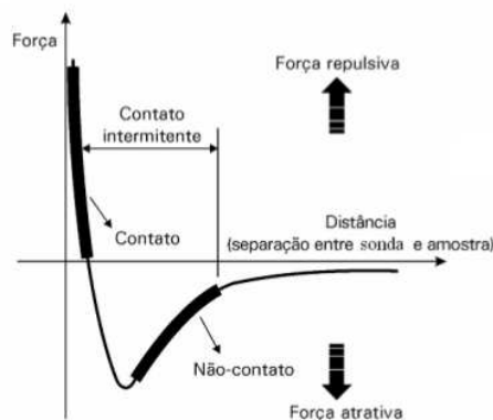
Figura 4.10: Relação da força entre ponta e amostra e regimes de operação. Retirada da referência [70].
