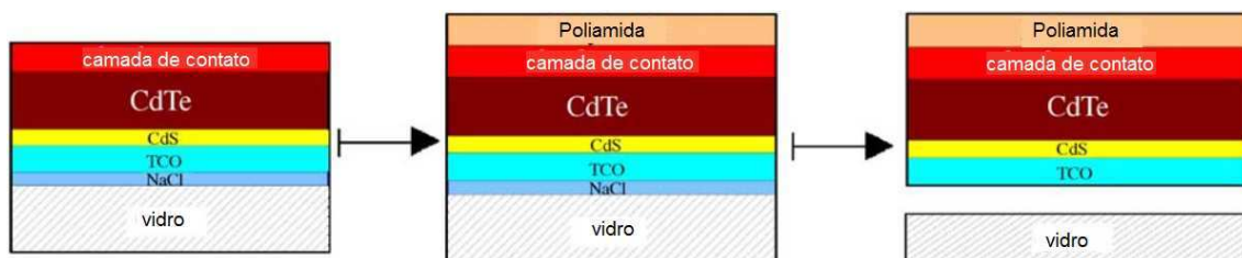
Figura 2.23: Esquema das etapas do processo de construção célula solar em poliamida na configuração substrato. Retirada da referência [42].
