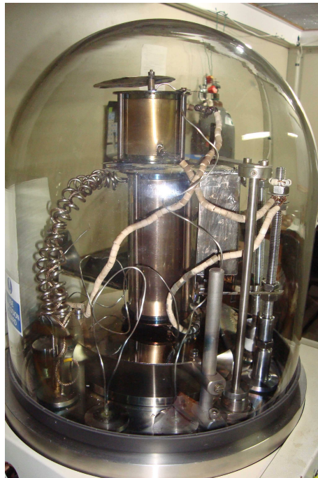
Figura 4.2: Equipamento de HWE - Laboratório de Epitaxia UFV: ambiente protegido por uma campânula de vidro (ambiente de vácuo). Durante o crescimento atinge-se pressão da ordem de 10^{-7} Torr.
