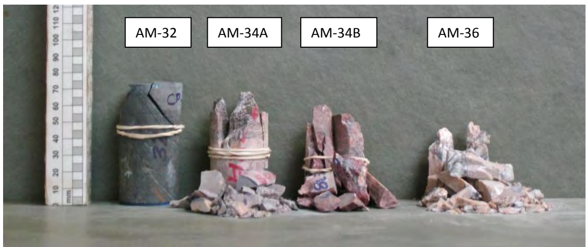
Figura 46: Ensaio Compressão Uniaxial. Amostra: Marga, Brecha Dolomítica. Corpos de prova AM-32, AM-34A, AM-34B e AM-36. Após Ruptura.
