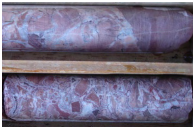
Figura 22: Brecha dolomítica da Mina de Vazante composta por clastos de dolomito e matriz também dolomítica com vênulas de sílica em testemunho de sondagem (diâmetro 3,6 cm).
