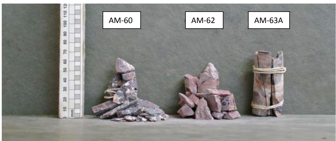
Figura 47: Ensaio Compressão Uniaxial. Amostra: Brecha Willemítica, Brecha Dolomítica. Corpo de prova 636 a 638. Após Ruptura.
