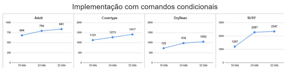
Figura 4.10: Quantidade de LUTs utilizadas para cada conjunto de dados em função do tamanho da palavra (16, 24 e 32 bits).
