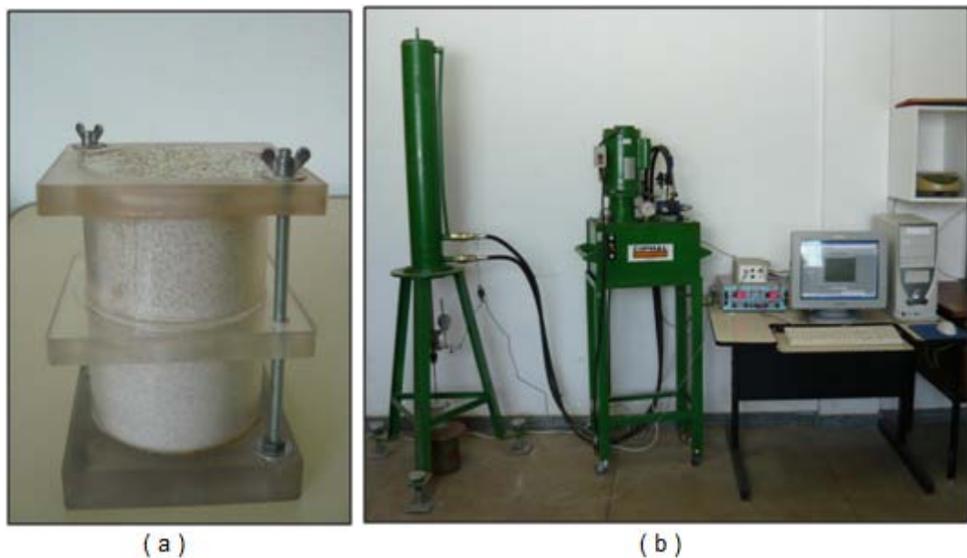
Figura 28: (a) Corpo de prova utilizada para ensaios de resistência de cone penetrométrico; e (b) sistema de cone penetrométrico quase-estático.
