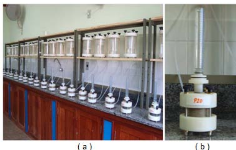
Figura 14: Sistema implementado por Dalla Riva (2010) para a realização de ensaios de condutividade hidráulica sob carga constante: (a) vista parcial do conjunto de permeâmetros; e (b) detalhe do permeâmetro, com a proveta graduada em cm.
