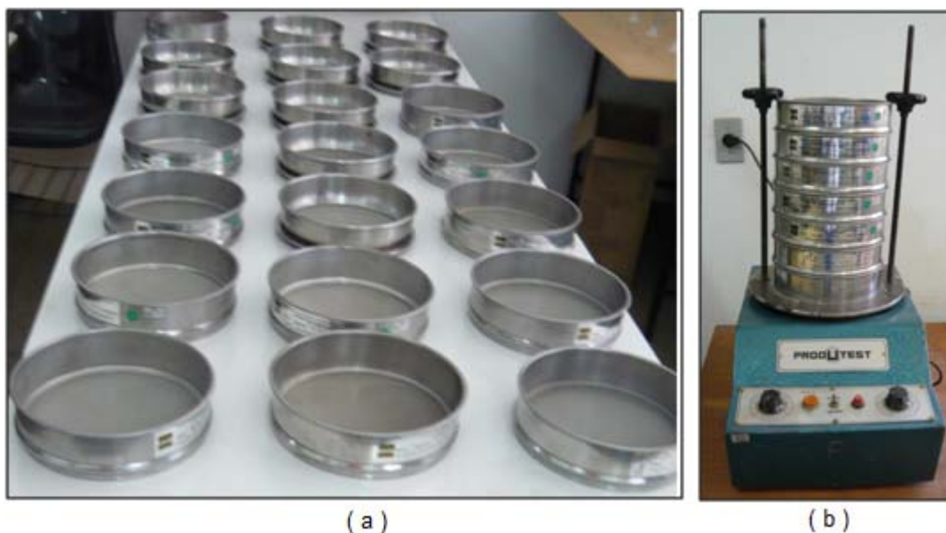
Figura 22: (a) Jogo de peneiras para o peneiramento da fração areia em 21 classes de tamanho; e (b) Imagem do agitador de peneiras empregado.
