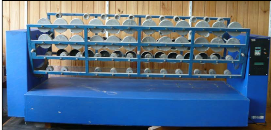
Figura 21: Agitador mecânico utilizado para grandes volumes de solo.
