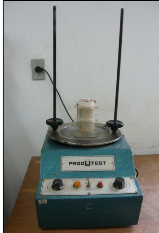
Figura 26: Vibrador de peneiras utilizado para empacotamento das partículas.
